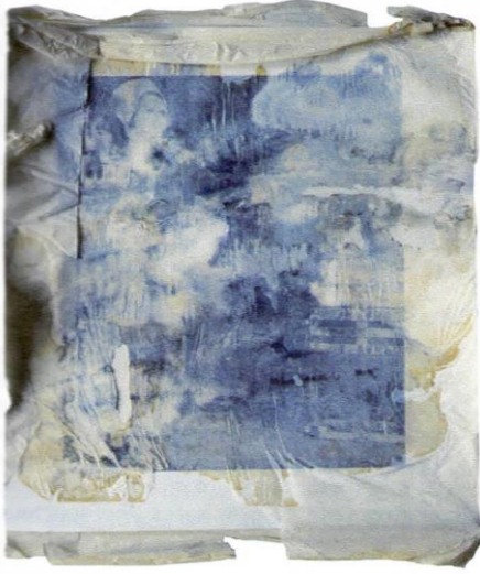
الصورة 141 : تعفن الصورة والتصاقها بكيسها الورقي، مصور مجهول، حوالي عام 1950م. عن: Lavédrine (B.), 2007, p.287.
