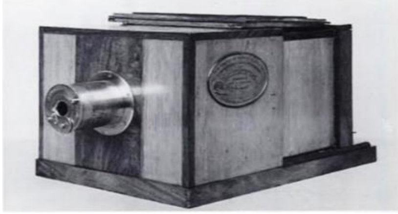
الصورة 11: كاميرا داغريوتيب عليها ختم الصانع جيرو وتوقيع داغير، تعود إلى سنة 1839م.
