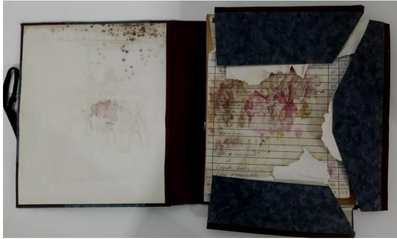
الصورة 222: تلتخ ألبوم الصور رقم A017 بيقع الرطوبة، و تأثر ورقة الجرد بيقع سواد و بنفسجية.
